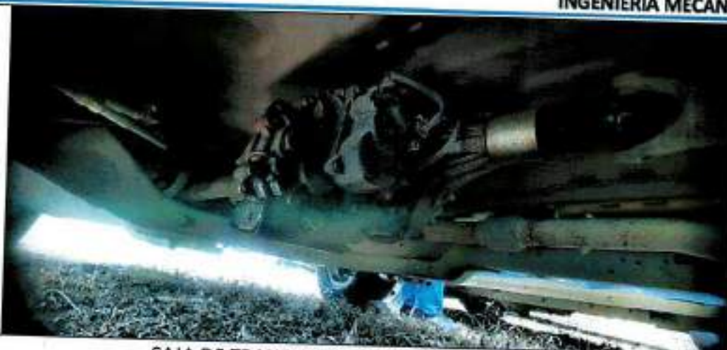
CAJA DE TRANSFERENCIA CON FUGA DE ACEITE
